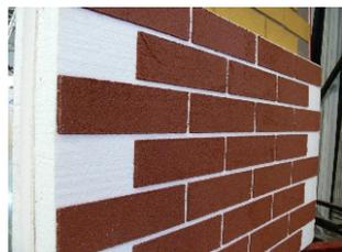
Фасадная термопанель на основе пенопласта ПСБ -35-С с нанесенным в заводских условиях защитным, декоративным-покрытием клинкерный кирпич.
