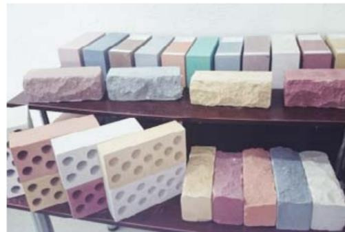
Силикатный кирпич широко распространенный стеновой материал. Он отличается сравнительно низкой стоимостью и хорошими строительными качествами: правильной формой, точными размерами и необходимой прочностью.
